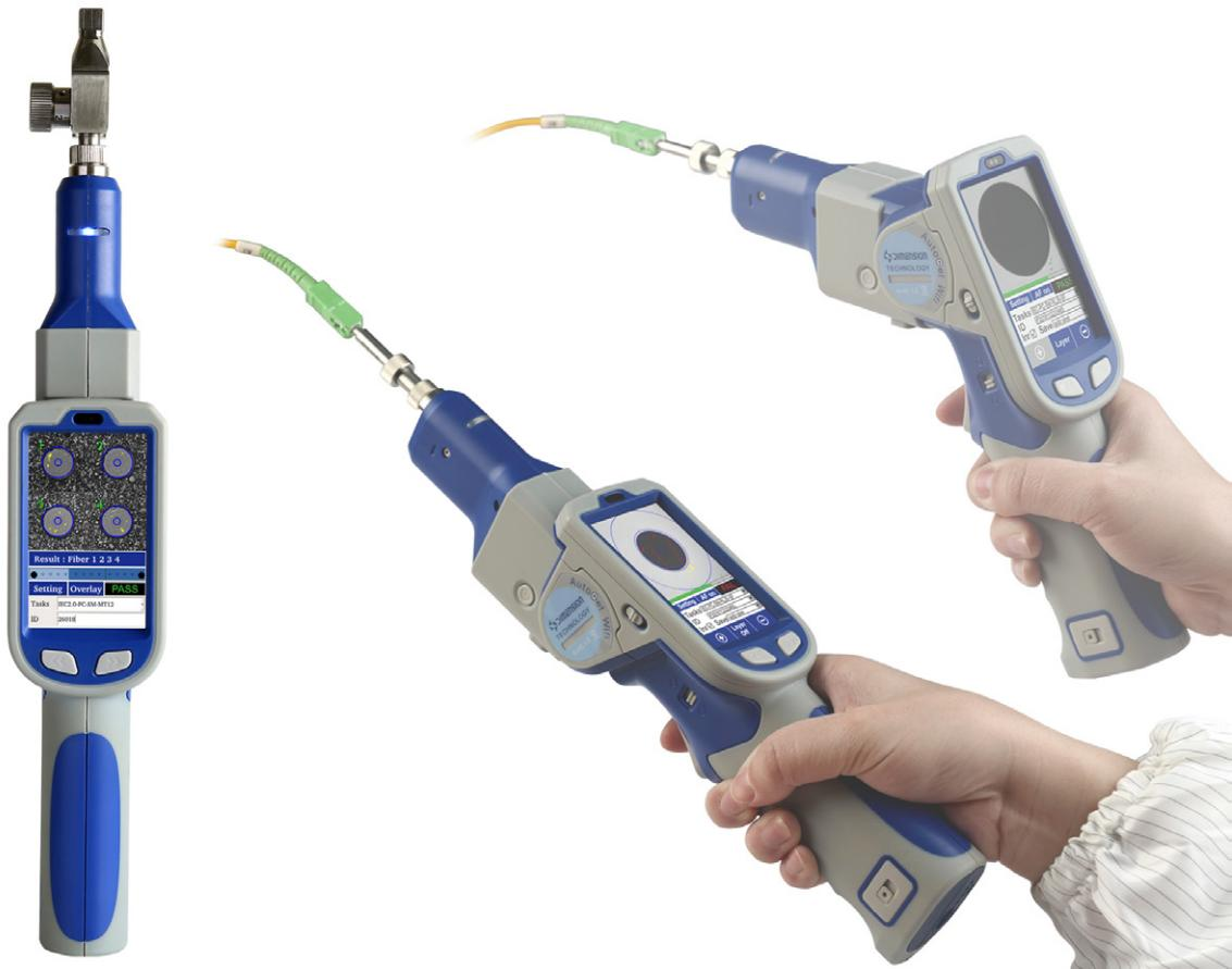
造成光纤网络问题的首要原因是连接器脏污或损坏，如何快速、高效的评估、诊断并分析光网络中因光纤端面不良而引起的问题显得尤为重要。
